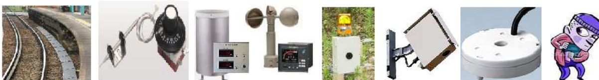
転落マット監視 設備温度上昇 大雨警報 強風警報 落石センサ 降雪センサ 漏水センサ 防犯センサ
