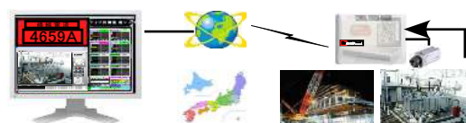
携帯電話のフォーマ網を利用した遠隔計測監視
