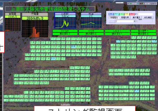
ストリング監視画面 電流値をリアルタイム表示
