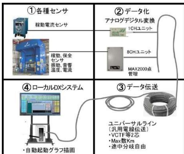
図 2 ローカル DX システムのハード構成
