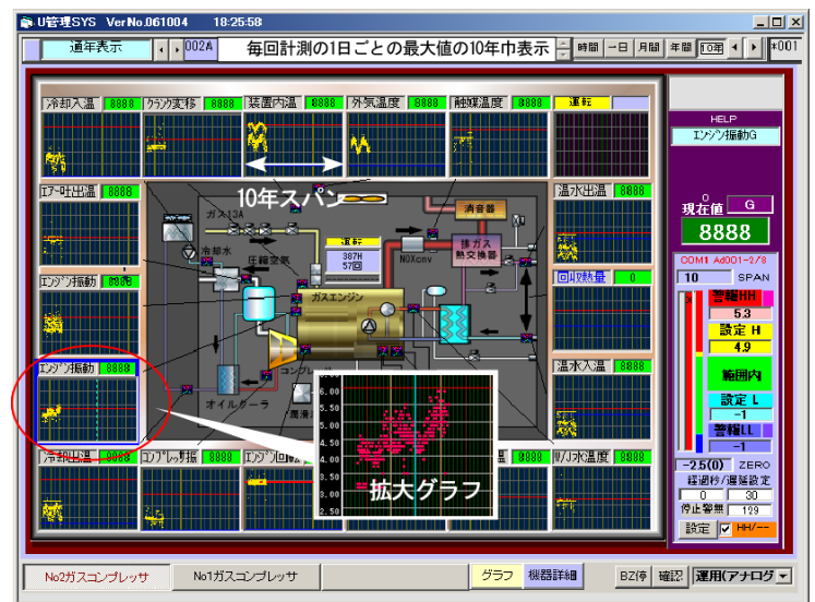
図5-真冬の温度ドリフトと経年劣化の兆候
